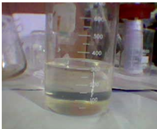
Figura 4: Parte do efluente filtrado após três horas de eletrólise.
