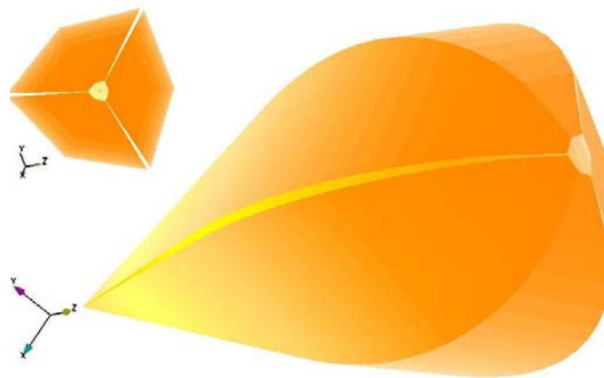
Figura 7. Cap model no espaço de tensões I_1x\sqrt{J_2}
