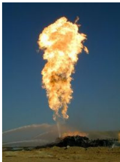
Figura 1: Blowout num poço onshore , na Argélia [ www.wellflow.no/Experience ]
