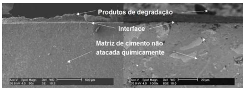
Figura 4. Aspecto das três zonas definidas após ataque ácido em HCl 15% em pasta de água e cimento: matriz de cimento não atacada quimicamente, interface e produtos de degradação.
