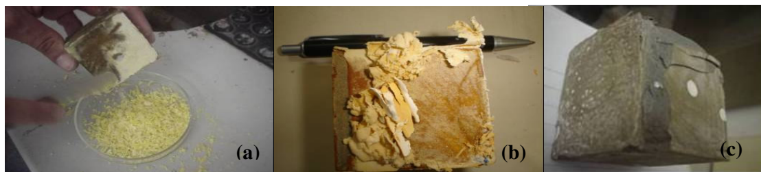
Figura 3. Camada degradada raspada em (a) pasta convencional e compósitos cimento/poliuretana em pó, (b) compósito cimento/poliuretana aquosa não iônica W320 e (c) interface de cor marrom.
