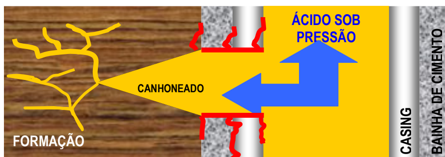
Figura 1. Detalhe do contato do ácido com a bainha de cimento e o revestimento na acidificação.
