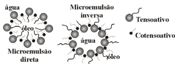
Figura 2. Estrutura de microemulsão O/A e A/O.
