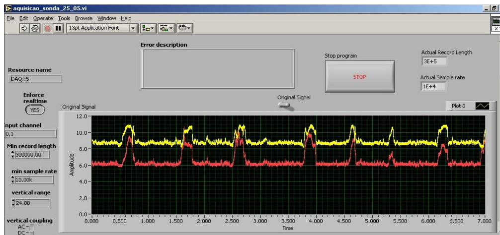
Figura 3 – Interface gráfica em ambiente LabView para aquisição de sinais das sondas de fios paralelos.
