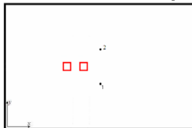
Fig. 5. Posicionamento das sondas de velocidade para \theta = 0 (tandem).
