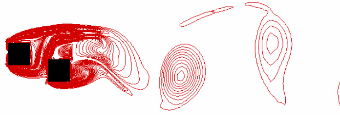
Fig. 14. Mapas de isovorticidade, \theta = 22,5^\circ , Re = 500 , t = 91s .
