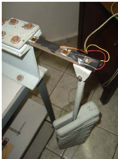
Figura 5. Ensaio de deformação do corpo de prova (calibração estática).
