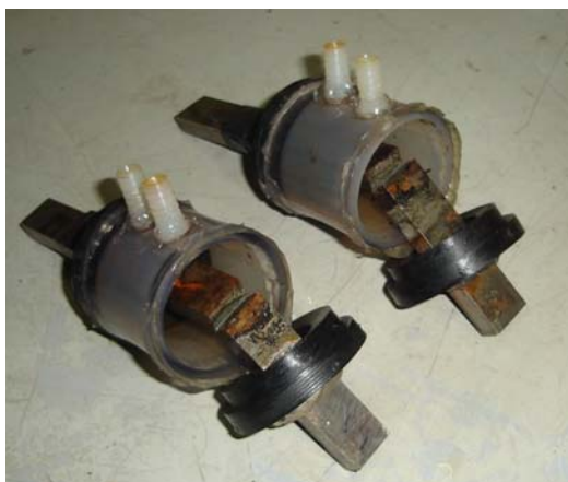
Figura 7. Corpos de prova que romperam durante os ensaios de corrosão-fadiga.
