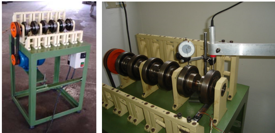
Figura 3. Máquina de fadiga desenvolvida. (a) Vista geral do conjunto; (b) Detalhes do sistema de acionamento e ajuste das cargas de flexão por came cilíndrica rotativa. Fonte: Silva (2006).
