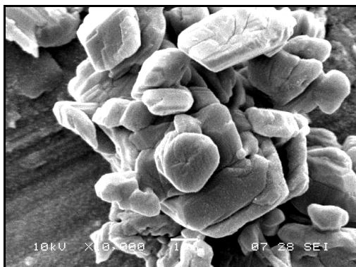
Figura 3: Micrografia MEV do Mo mássico, ampliação de 10.000 vezes.
