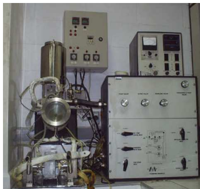
“Figura 1. Destilador Molecular Centrífugo, disponível no LPDS/LOPCA/FEQ/UNICAMP”
