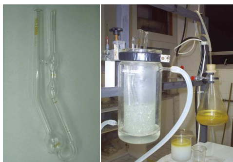
“Figura 2. Viscosímetro Cannon-Fenske 200 e aparatos para medição da viscosidade cinemática”
