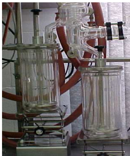
Figura 2.2: Foto em detalhe dos carrosséis coletores de resíduo e destilado
