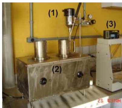
Figura 2. Sistema utilizado na modificação do CAP. (1) Agitador magnético (Fisatom modelo 713D) (2) Panela elétrica (3) Termômetro digital (Salvterm 700k – Salcas)
