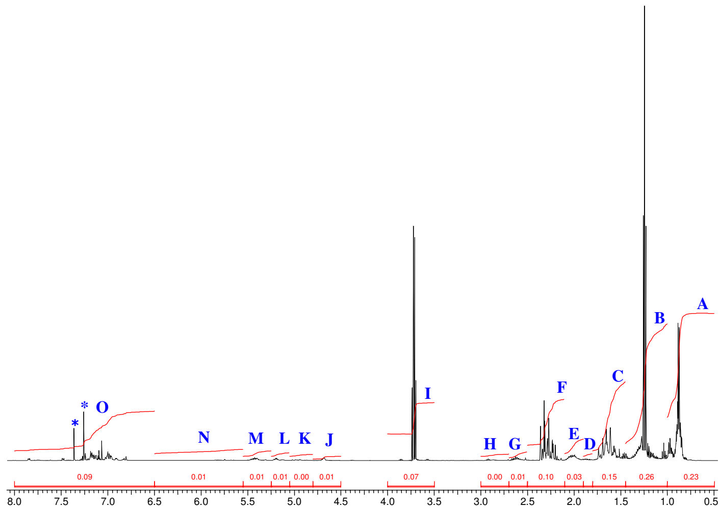
Figura 1. Espetro de RMN ^1\text{H} ( \delta ) a 500 MHz em \text{CDCl}_3 de uma típica gasolina C, com as regiões de integração (A a O) usadas na correlação. * Sinal do \text{CHCl}_3 e * Sinal do Benzeno (Região de Integração P ).
