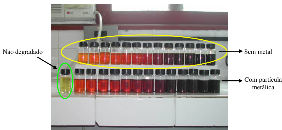
Figura 4. Visão das amostras degradadas em função do tempo/temperatura de exposição térmica a 210°C.
