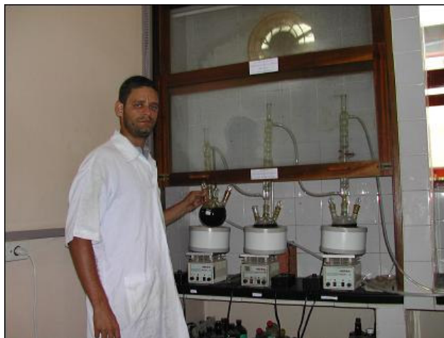
Figura 1. Sistema para envelhecimento térmico dos óleos.
