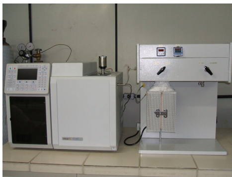
Figura 1 - Unidade de reação utilizada para a avaliação catalítica.
