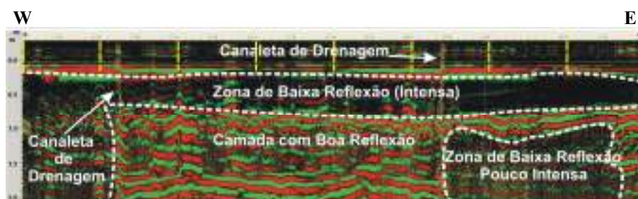
Figura 6 – Perfil 5 realizado no posto Carvalho III, mostrando o contraste lateral entre a zona de baixa reflexão e camada de boa reflexão.
