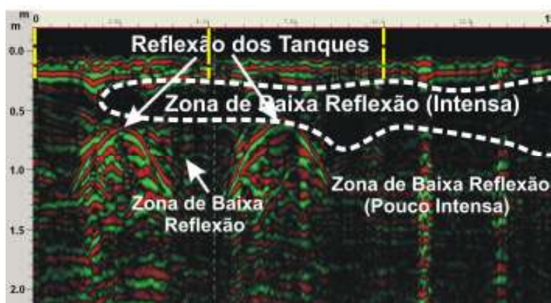
Figura 4 – Perfil 3 realizado no posto São Paulo, Abaetetuba-PA, mostrando o domínio das zonas de baixa reflexão próximo aos refletores de tanques de gasolina.
