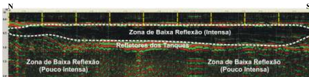
Figura 7 – Perfil 6 realizado no posto Carvalho III, mostrando os refletores de tanque em meio a zonas de baixa reflexão.
