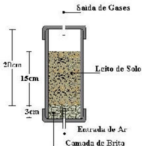
Figura 4 - Representação esquemática do biorreator aeróbico de Leito fixo.
