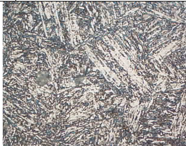
Figura 2. Aço inoxidável martensítico 13 Cr – Aumento de 500X. Ataque químico: Reativo de Vilella.
