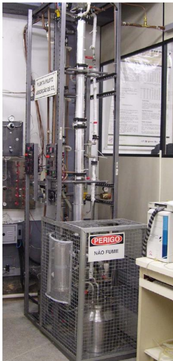
Figura 1 – Planta Piloto da Absorção de CO 2 .
