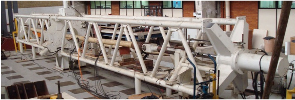
Figura 1 – Vista geral da Máquina Tração – Torção.
