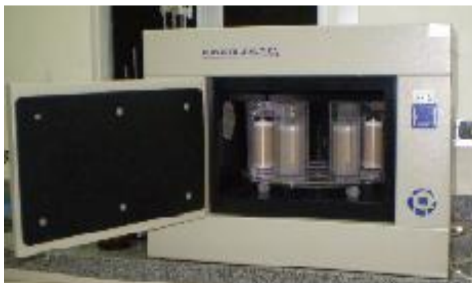
Figura 01: Digestor por microondas, modelo DGT 100 Plus da Provecto Analítica.
