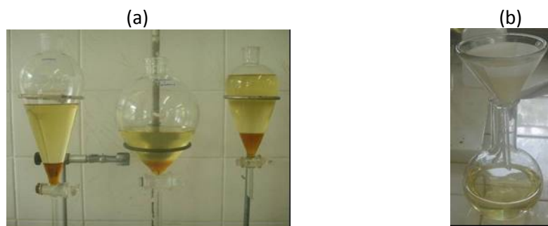
Figura 1 – (a) Etapa de decantação e de (b) filtração do processo de fabricação de biodiesel.
