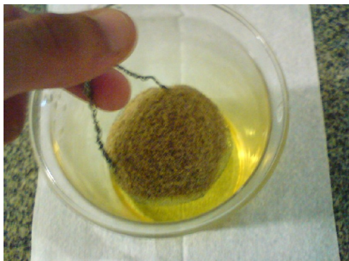
Figuras 1 e 2 – Ensaio de retenção de óleo lubrificante em bagaço de cana-de-açúcar, utilizando uma rede metálica para a remoção posterior.
