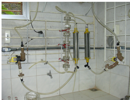
Figura 1 - Aparato experimental mostrando a coluna de extração líquido-líquido de pratos perfurados associada aos rotômetros e as bombas.
