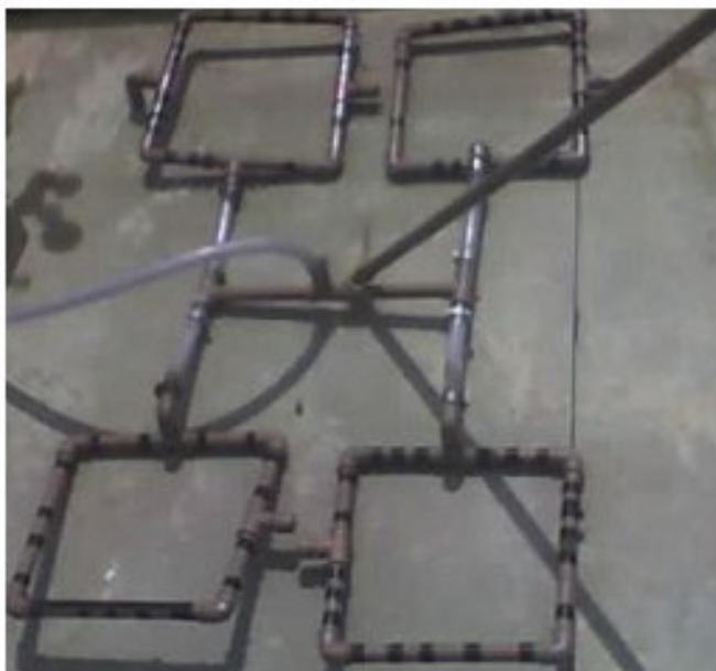
Figura 2. Dispersor de bolhas montado com tubos de PVC para fornecer as bolhas de ar para o interior do tanque.
