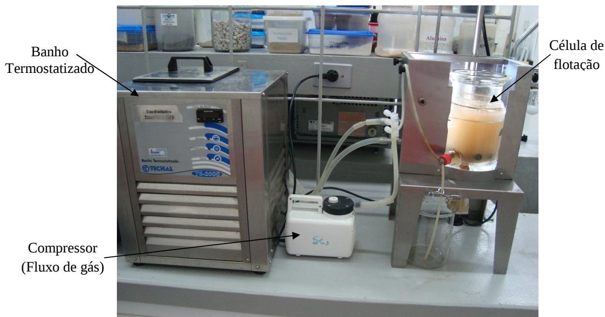
Figura 01: Célula de flotação de bancada e banho termostatzado acoplado.
