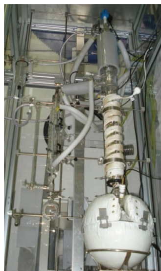
Figura 1 – Sistema ASTM D 2892 UFES
