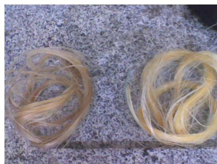
Figura 2 – Fibra aderida com a dietanolamina (esq.) e com trietanolamina (dir.)
