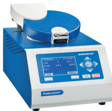
Figura 1: Equipamento utilizado para avaliação da estabilidade à oxidação PetroOxy (Petrotest)
