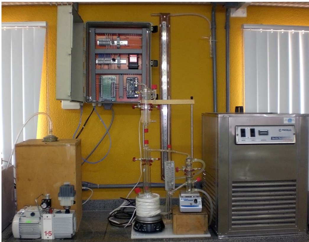
Figura 2. Aparato desenvolvido para a Célula Othmer automatizada e para baixas concentrações
