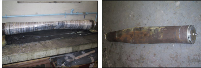
Figura 3. Corpo de prova T2SFE-02 colapsado após ter sido submetido à pressão externa na câmara hiperbárica.
