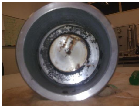
Figura 5. O'ring rompido, posicionado no cabeçote.
