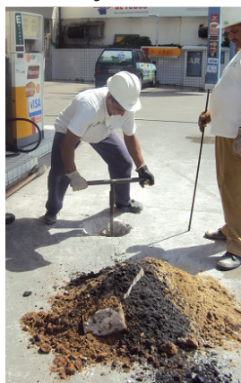
Figura 1: (A) Sondagem a Trado Manual; (B) Coleta de solo; (C) Coleta de água com bailer 1 .
