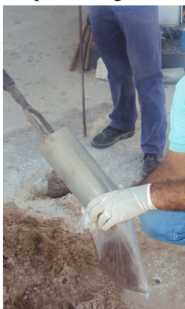
Figura 1: (A) Sondagem a Trado Manual; (B) Coleta de solo; (C) Coleta de água com bailer 1 .
