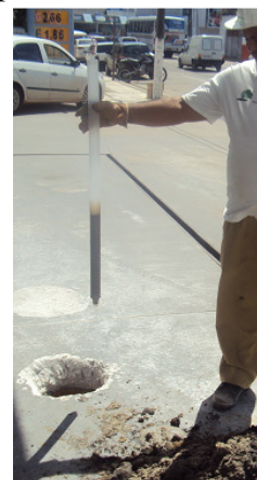
Figura 1: (A) Sondagem a Trado Manual; (B) Coleta de solo; (C) Coleta de água com bailer 1 .
