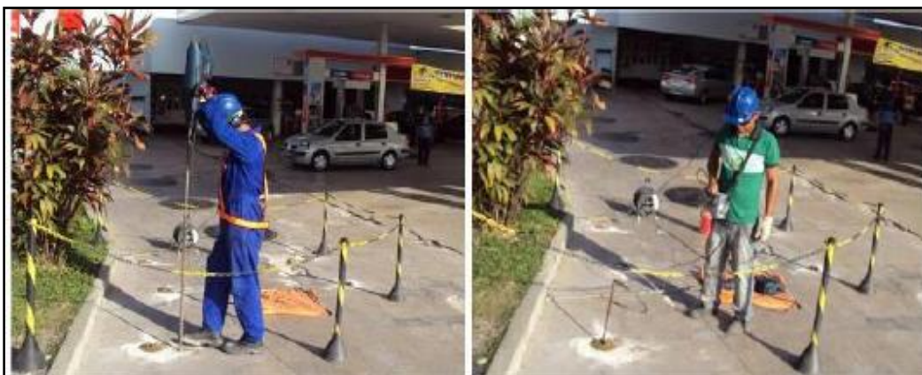
Figura 2 – Operação de sondagens de VOC
