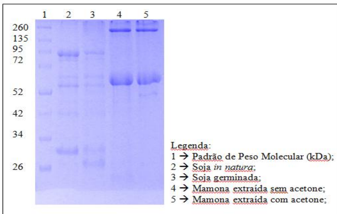
Figura 1. Eletroforese SDS-PAGE de extratos enzimáticos obtidos a partir de sementes de mamona e soja.
