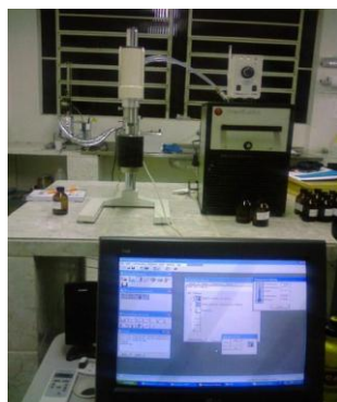
Figura 1 - Reômetro rotacional (Thermohaake, modelo VT550, Paramus, EUA), com geometria de cilindros concêntricos (MV/MV1), conectado ao computador.
