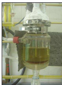
Figura 1: Reator de produção de biodiesel
