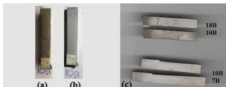
Figura 2. Amostras 10B após jateamento. (a) 60 segundos com abrasivo 20 mesh, (b) Após terminado o processo. (c) Redução de espessura no metal de base - vista lateral.
