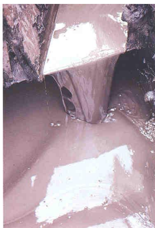
Figura 1: Fluido de Perfuração Conhecido como “Lama de Perfuração”.
