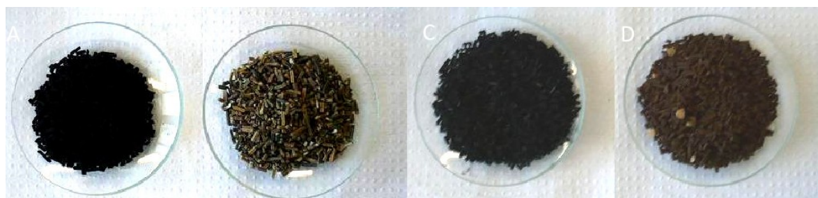
Figura 4: Aspectos dos catalisadores: NiMo “gasto” (A); NiMo pré-oxidado (B); CoMo “gasto” (C); CoMo pré-oxidado (D)
