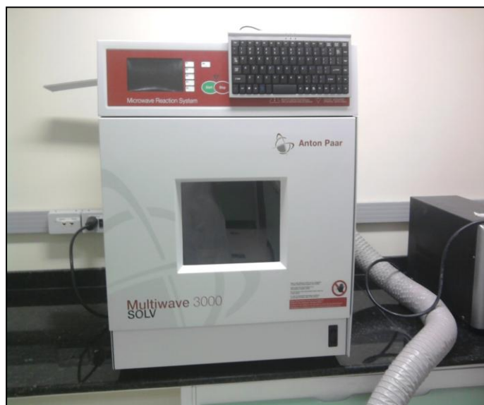
Figura 01 - Extrator po Microondas da Anton Paar.
