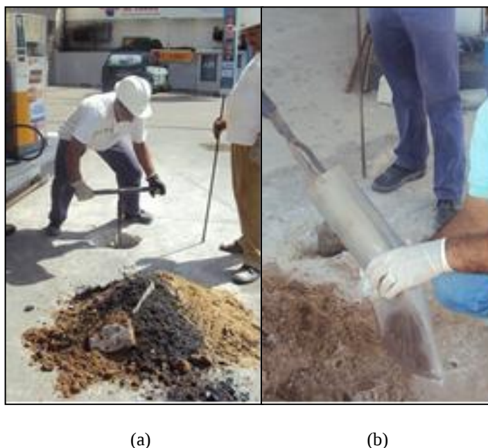
Figura 01 - (a) Sondagem a Trado; (b) Coleta de Solo
