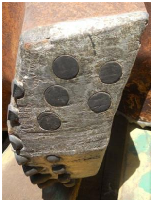
Figura 1 - Broca do tipo PDC desgastada
