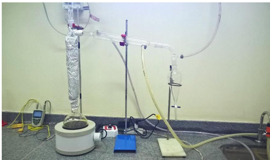
Figura 02: Aparato utilizado na etapa de destilação em escala de bancada.
