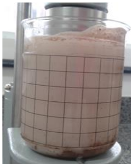
Figura 7: Teste de remoção do colchão lavador selecionado.
