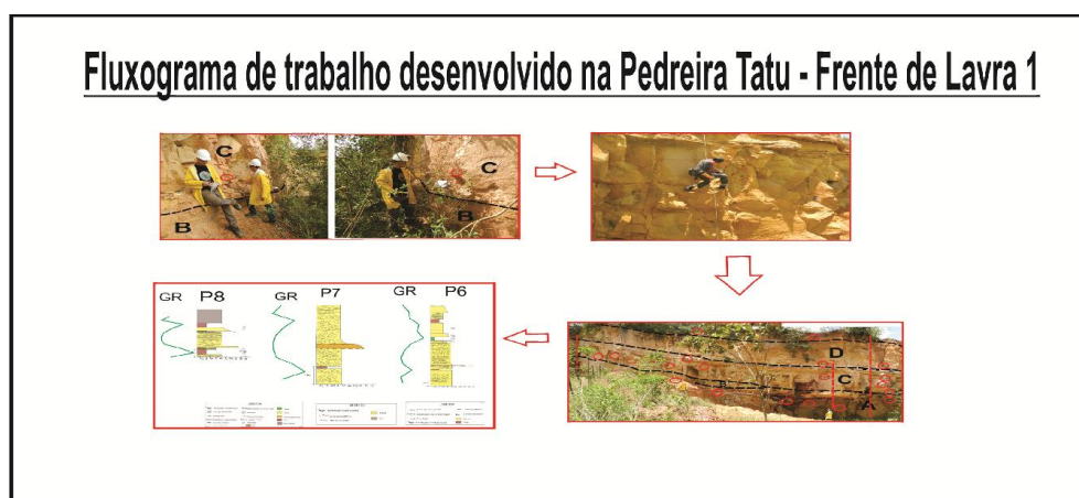
Figura 2: Fluxograma mostrando as fases de trabalho, com a utilização do rapel para coleta e descrição das amostras, seguido da caracterização do afloramento separando-o por camadas, e por fim, confecção de perfis litológicos integrando todas as informações obtidas.
