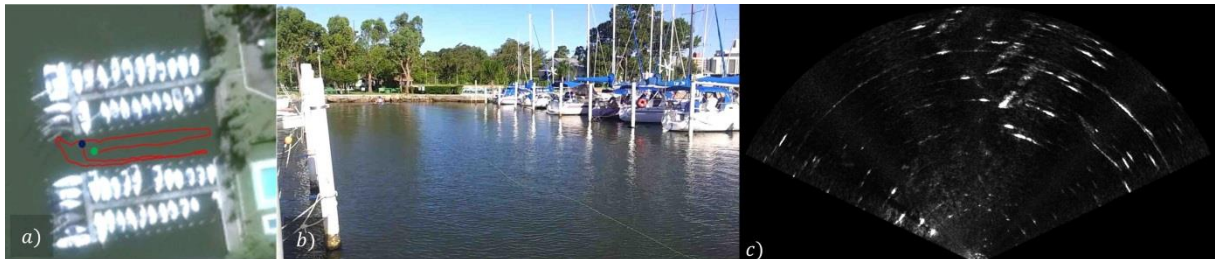
Figura 3 - Imagens do Dataset ARACATI2014 (Silveira et al.,2015). a) O trajeto percorrido pelo ROV em vermelho, os pontos azul e versão são os pontos de início e término da trajetória. b) Imagens do local. c) Uma imagem acústica capturada pelo ROV no local.
