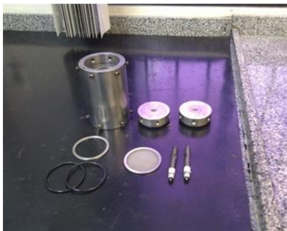
Figura 2: Célula para ensaio de determinação de Filtrado desmontada
