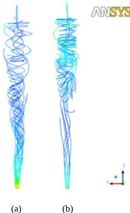
Figura 3 - Linhas de fluxo da água para velocidades (a) 4 m/s e (b) 25 m/s.
