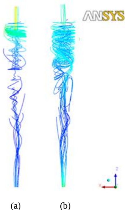
Figura 2 - Linhas de fluxo do óleo para velocidades (a) 4 m/s e (b) 25 m/s.
