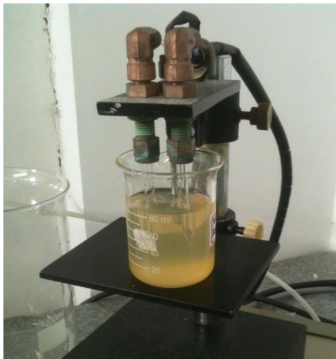
Figura 1: Tensiômetro usado para medição da tensão superficial do filtrado
