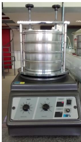
Figura 4 - Equipamento formado por peneiras utilizado (Fonte: Autor próprio, 2015).
